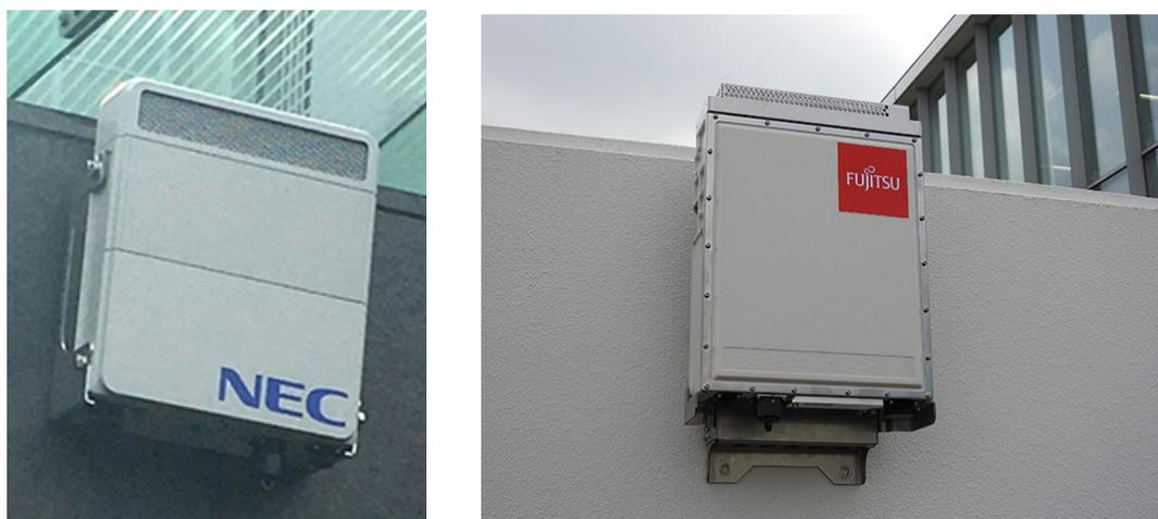
Fig. 9-5 ミリ波RUの外観 (NEC製、富士通製)
