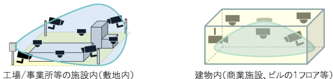
Fig.7-5 ローカル5Gで4Kカメラによる映像監視をする場合のイメージ
