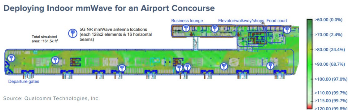
Fig. 5-5 空港における5Gミリ波基地局の設置例および伝搬損測定結果
