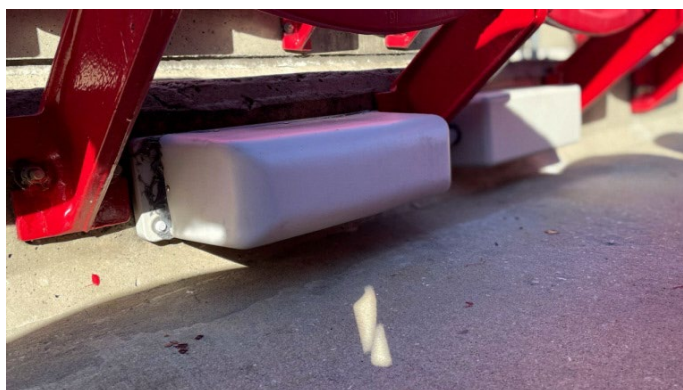
Fig. 8-1 スタジアムのシート下に設置された5Gミリ波のスマートセル
